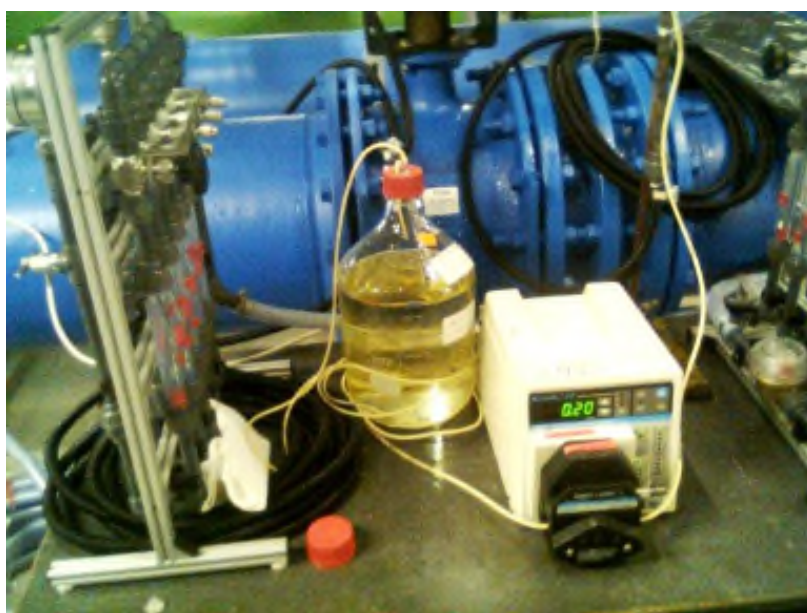
Fig. 1. CBM, teflon aanvoerleiding, FeCl_3 -oplossing en doseerpomp.
